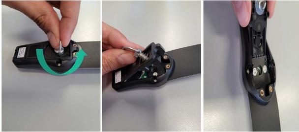
2. Entnehmen Sie die Leiste, setzen Sie eine neue ein und stellen Sie sicher, dass die Anschlüsse an der Leiste und der Platine korrekt aneinander ausgerichtet sind.
