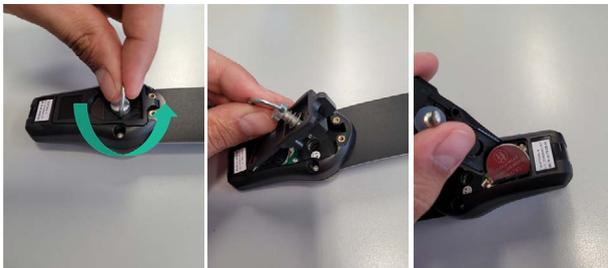
2. Setzen Sie die neue Batterie ein und bringen Sie die Abdeckung wieder an. Drehen Sie den Ring dabei um 90° im Uhrzeigersinn.
